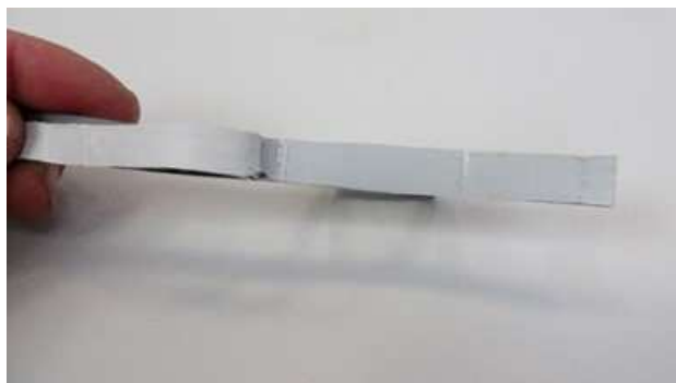
Obr. 14: Nedostatečná kvalita svaru – svar se rozlupuje
