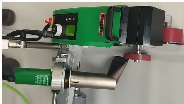
Obr. 26: Navařování profilu automatickým svařovacím přístrojem
