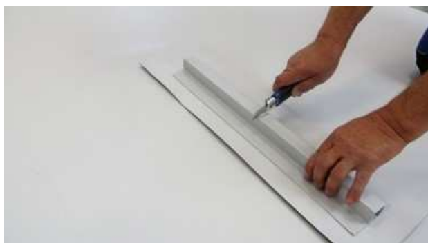
Obr. 10: Nařezání zkušebních těles pro zkoušku spoje v odtržení
