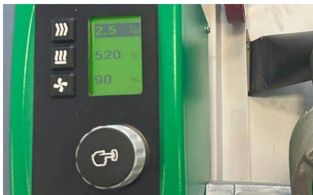
Obr. 7: Příklad nastavení přístroje Leister Varimat V2
