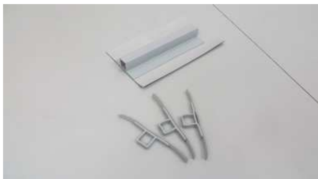
Obr. 11: Připravená zkušební tělesa šířky 10 mm
