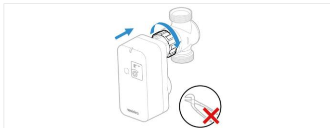
Obr. 3 Montáž pohonu na ventil
