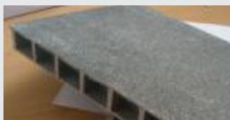
Zakrývající systém s nízkou hmotností je řešen pomocí roštů s uzavřeným laminátovým povrchem. Standardní bezpečností podlahy jsou opatřeny protiskluzovým povrchem, jenž je tvořen křemičitým pískem zalitým v pryskyřici.
