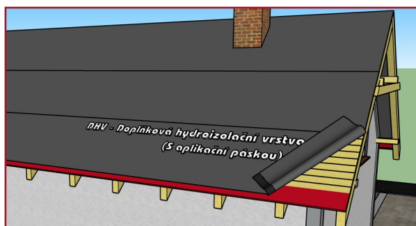
Aplikace pojistné hydroizolační vrstvy (DHV)
