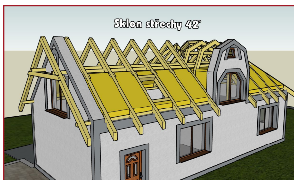
Kontrola rovinnosti a příprava krovu
