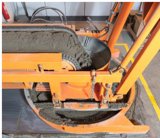
Plnění formy jemnozrnným betonem s nízkým vodním součinitelem
