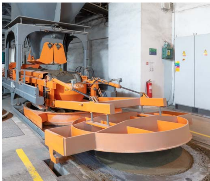
Proces výroby polotovaru systémem vibrolisování
