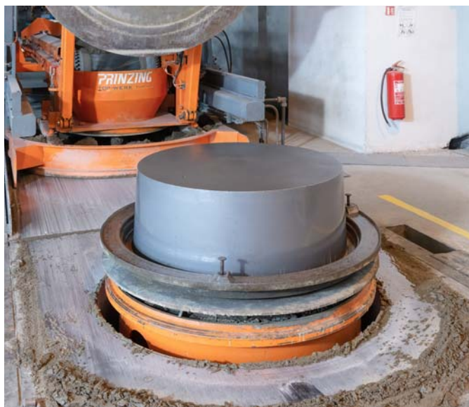
Vibrolis Prinzing/Atlas – strojní zařízení pro výrobu polotovaru šachtového dna
