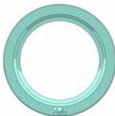
Značení trouby zkrácených délek (4 nebo 4,5 m) na čele hrdla trouby.
