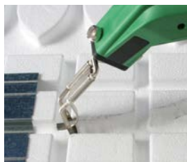
Vytvoříte doplňkové kanály pro rozvody trubek jednoduše pomocí x-net tavné rezačky.
