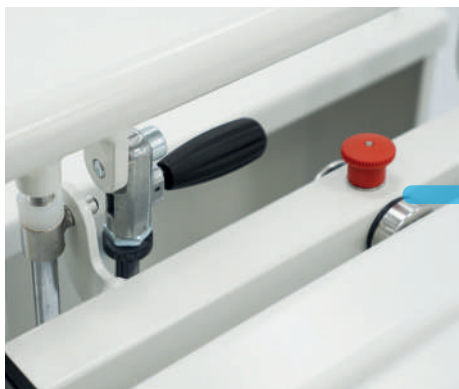
Tlačítko a páčka pro nastavení polohy stolu.
