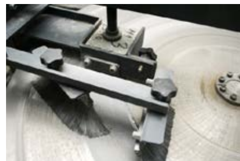
DLAŽBA PŘI ZKOUŠCE OBRUSNOST POVRCHU
