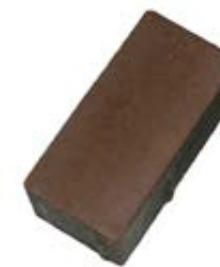
Povrch dlažby bez vápenného výkvětu
