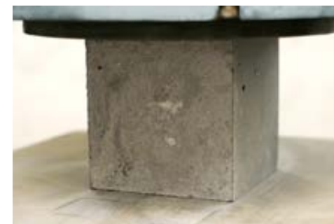
BETON PŘI ZKOUŠCE PEVNOST V TLAKU
