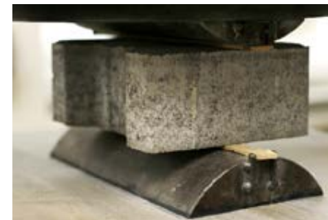
DLAŽBA PŘI ZKOUŠCE PEVNOST V PŘÍČNÉM TAHU
