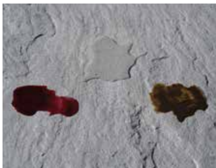
Znečištění – víno, vyjetý olej, voda
