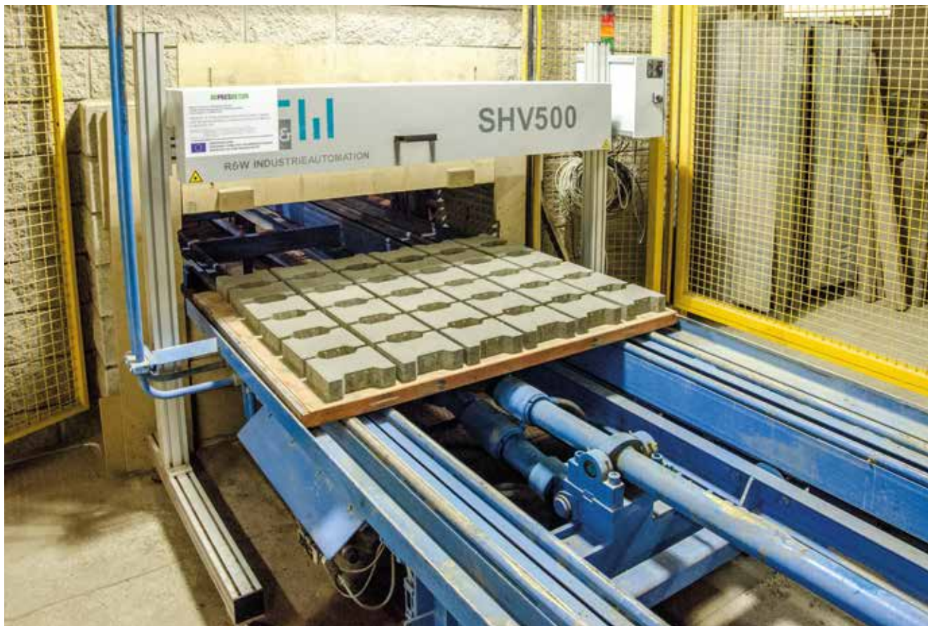
Měřicí část kontrolního systému SHV 500
