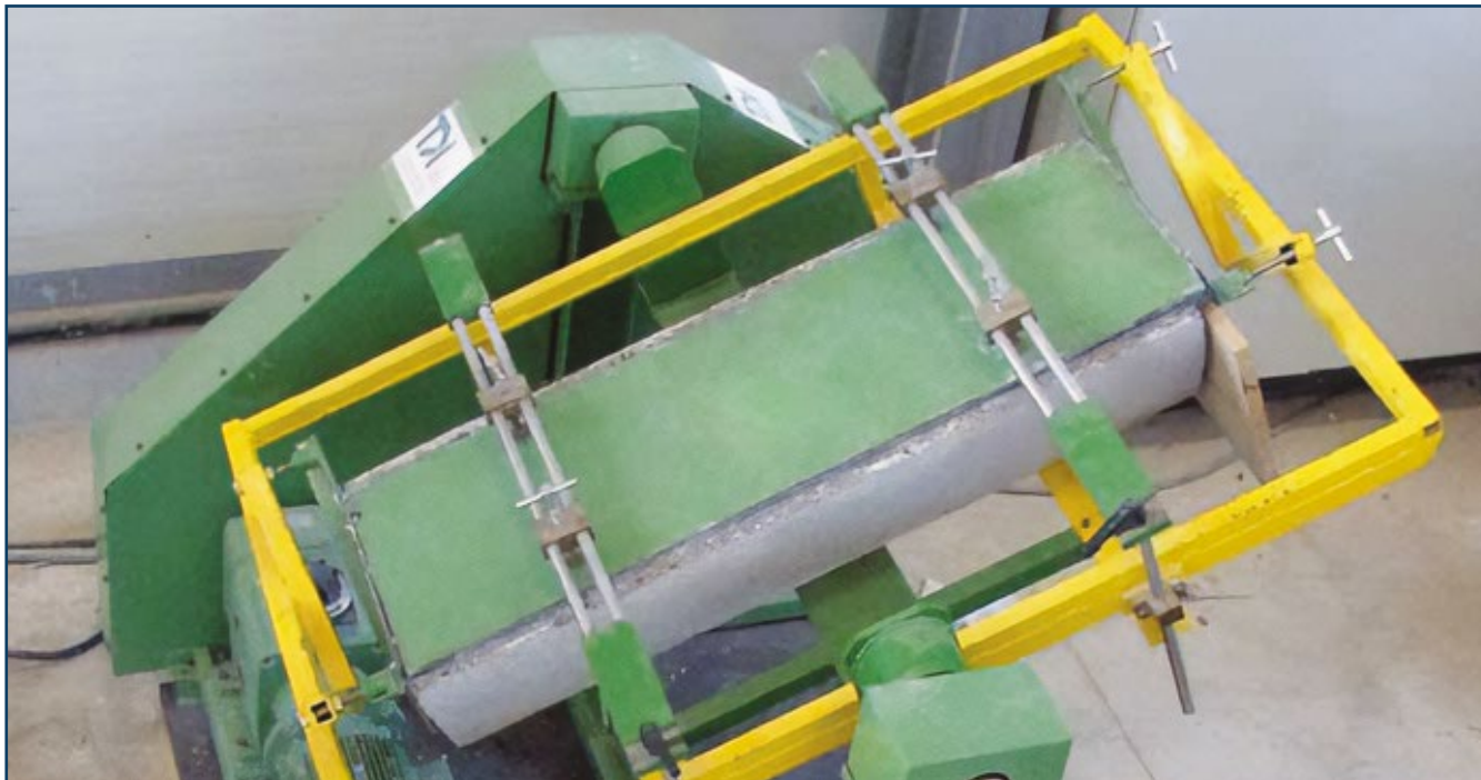
Tzv. „Darmštatský žlab“ pro zkoušení odolnosti proti otěru.
