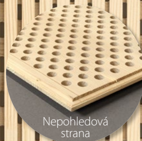
Profil S/L – pohledová strana drážkování 4/12, nepohledová strana vrtání 16/32-32 Dřevina: pouze jedle
