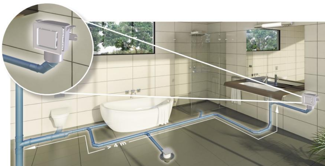
Obrázek 4: Délka potrubí větší než čtyři metry mezi umyvadlem a splaškovým odpadním potrubím
