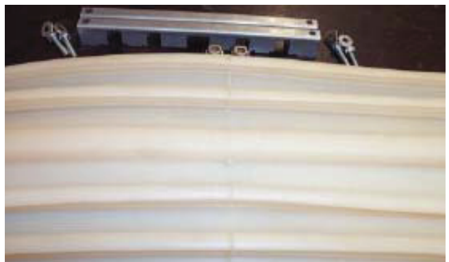
V. Schweißmatrize entfernen, abkühlen lassen und prüfen, ob Verschweißung ordnungsgemäß erfolgt ist. Falls nicht, muß die Verschweißung gem. den Punkten I-IV wiederholt werden. Release jig, allow to cool and inspect welded joint for continuity of weld and correct alignment of profiles. If the weld is unacceptable repeat operations I-IV.
